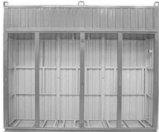
Vista general de estructura, sin la aislación de espuma de poliuretano
