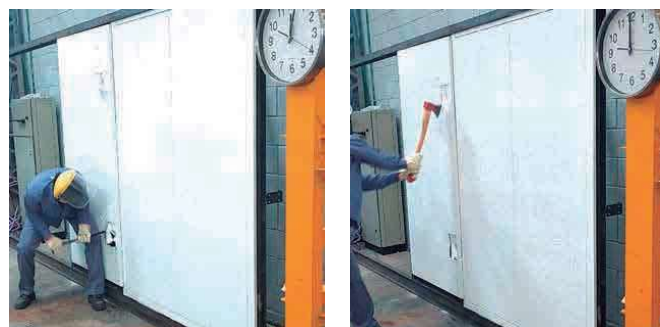
*Ensayo balístico posterior al ensayo de FR120
